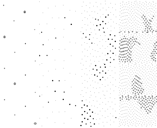
Fig. 4 Capas de neuronas asociadas con una neurona seleccionada de la capa cuatro. Se muestra la neurona seleccionada en la cuarta capa y las asociadas en las capas tres, dos y uno de izquierda a derecha en una distribución esférica uniforme en proyección cilíndrica.
