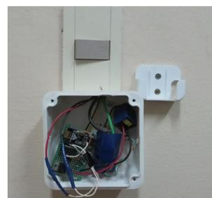
Figura 3: Interruptor y nodo domótico instalado
